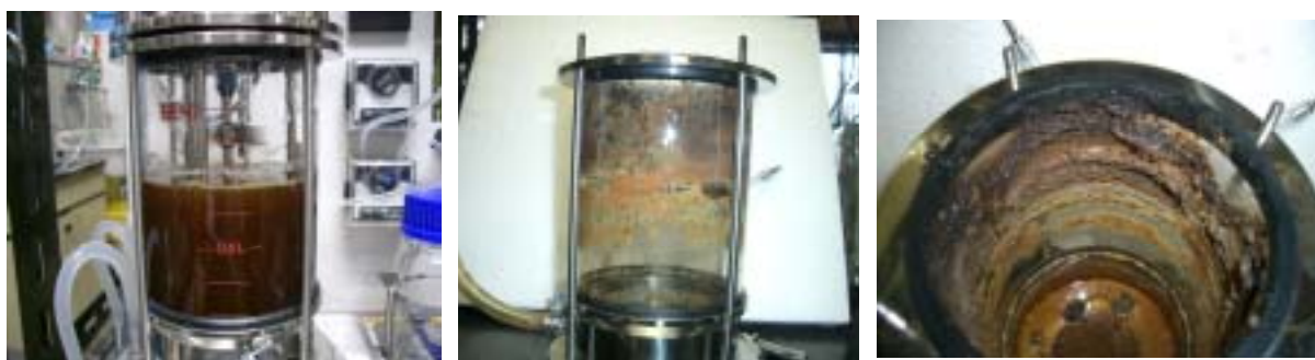
図 5.5.2 実験開始時の発酵槽と、連続培養により発酵槽に付着したバクテリアの様子
