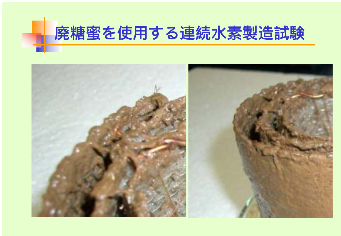
図 11 水素発酵菌がコイル状ガーゼに凝集した状態
