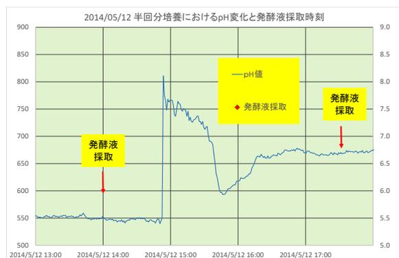
図 2. HN001 株で半回分培養を行った際の発酵液 pH の変化と発酵液採取時点
